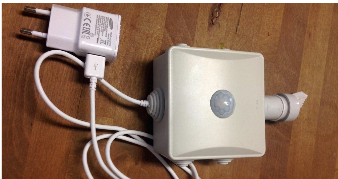
Fig. 33 - Foto di un "TUPWA": si vedono la sonda di presenza e quella di temperatura e umidità.
