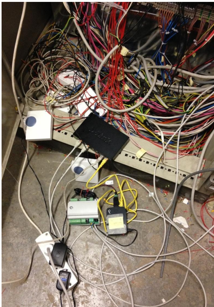
Fig. 21 - Nodo gateway collegato ad un Raspberry, prova in campo.
