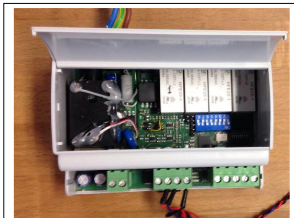
Fig. 15 - Hardware dei dispositivi a onde convogliate.
