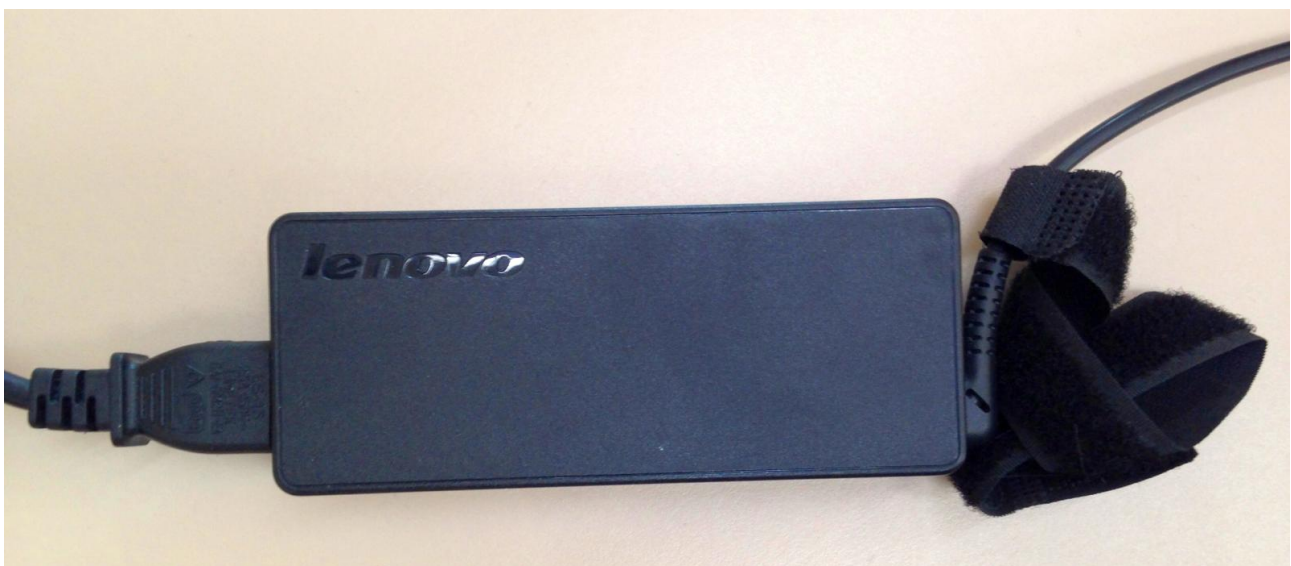
Fig. 27 - Un esempio di alimentatore che causa il "congelamento" delle misurazioni.
